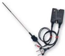
Aces generuje malý stejnosměrný proud, který udržuje optimální potenciál mezi jeho titanovou elektrodou a pláštěm zásobníku. Zásobník tím chrání proti případné korozii. Přístroj stále měří velikost tohoto potenciálu a dle potřeby okamžitě upravuje jeho velikost a udržuje ho na optimální úrovni. Neopotřebovává se, nevyžaduje údržbu a prodlužuje životnost zásobníků.
