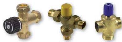
Termostatické ventily zajišťují bezpečnou konstantní teplotu na odběrových místech teplé vody, chrání spotřebitele před opařením. Lze je využít pro nejrůznější sestavy se zásobníkovými ohříváči v solárních soustavách nebo v systémech s kotli na tuhá paliva. K termostatickým ventilům je možno dodat sadu zpětných ventilů.
